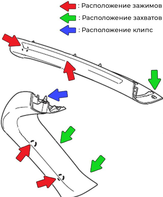
**2** Снимите панель облицовки двери багажного отделения.
